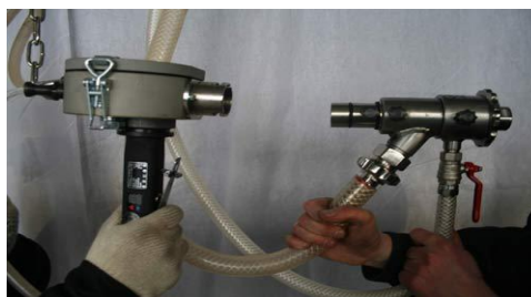
5 Сурет – Жұмыс басталмастан алдын шыныфибробетонды шаңдату пистолетінің екі бөлігін байланыстыру
