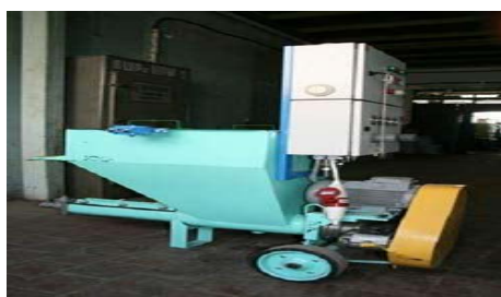
8 Сурет – СО-150УМ3 моделіндегі араласпа насосы
